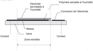
La zone sensible de la surface active du capteur doit être manipulée avec le plus grand soin pour éviter toute contamination ou dommage tels que résidus, éclats de soudures ou marques de doigts. Les contaminations et les dommages en dehors de cette zone peuvent altérer la fonction de mesure uniquement dans des cas très exceptionnels.
