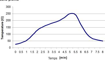
Le profile exact doit être optimisé pour le système de soudure des composants CMS. La température maximum de 250 °C ne doit pas être dépassée pendant plus de 3 minutes et le temps spécifié doit être observé. Le temps complet de soudure ne doit pas excéder 10 minutes à une température n'excédant pas 180°C.
